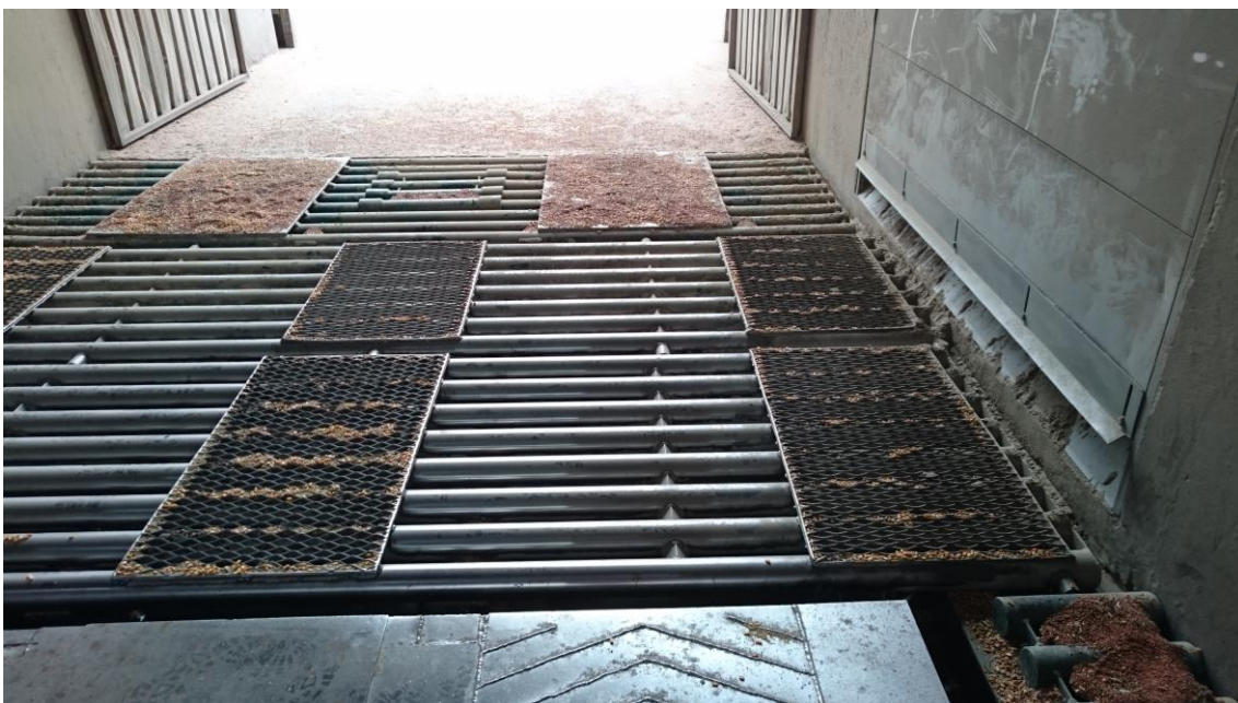
Ilustración 3 Rejilla de tolva de recibo, la que se debe de cubrir con las trampas de polvo basculantes por debajo.
